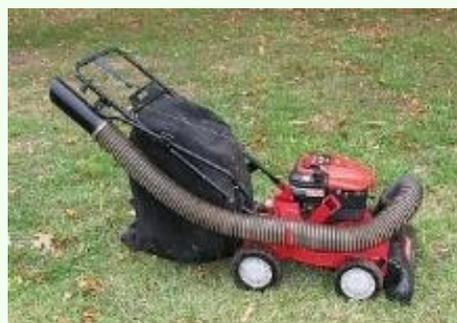
importante ricordarsi di non utilizzarli in presenza di terreno umido: oltre al rischio di impantanare l'aspirafoglie, vi è anche quello di aspirare terreno umido che a lungo andare potrebbe danneggiare il funzionamento interno. In caso di periodi di non utilizzo, inoltre, l'aspirafoglie va conservato all'interno di luoghi asciutti ed al riparo da umidità eccessiva e sole battente, meglio se accuratamente coperto come protezione contro l'accumulo di polvere.
